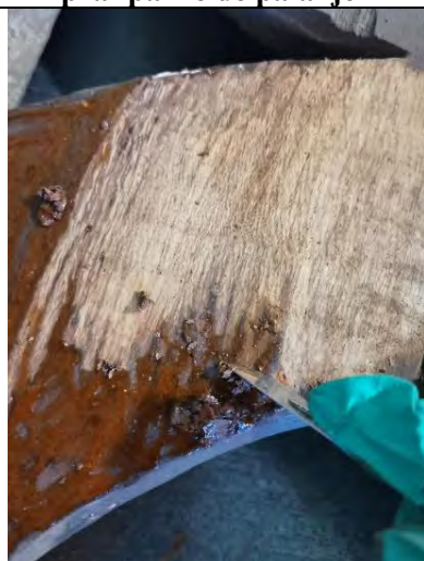
Foto 11. Îndepărtarea stratului de vopsea de la nivelul versoului și canturilor
